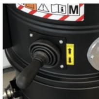
Sur un côté de la chambre de filtration il y a un secoueur manuel ergonomique qui permet de nettoyer le filtre facilement et rapidement, en éliminant poussière et débris de la surface du filtre. Grâce à ce système de décolmatage, l'opérateur peut continuer à travailler sans changer ou nettoyer le filtre.
