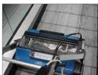
Support d'autoguidage breveté, avec roues cannelées.
