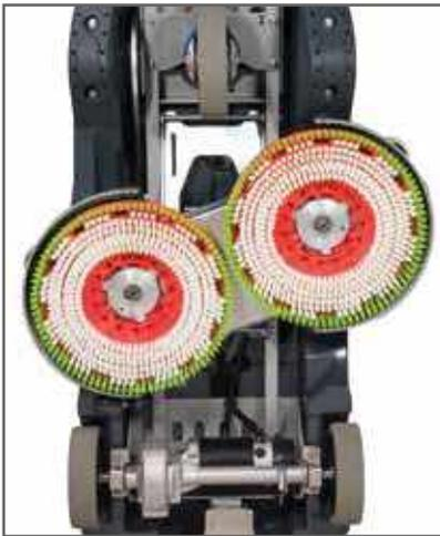
La version 8072 offre la plus grande des largeurs de travail pour une autoportée compacte, grâce à ses 2 brosses. L'accès aux batteries est direct pour une maintenance aisée.
