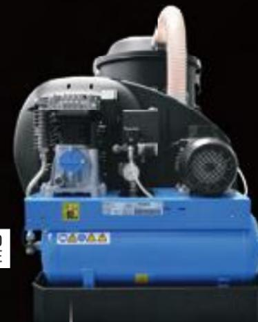
LE SYSTEME SP PERMET DE MAINTENIR LES FILTRES PROPRES AUTOMATIQUÉMENT SANS ARRÊTER L'ASPIRATION. CHAQUE FILTRE EST PÉRIODIQUÉMENT DÉCOLMATÉ PAR UN JET D'AIR HAUTE DÉBIT (6 BAR)
