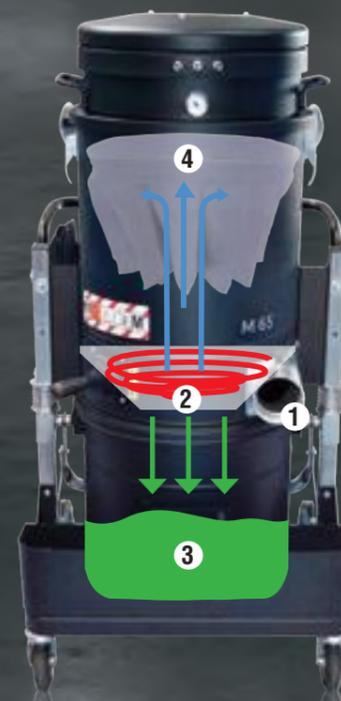
LE MATERIEL ASPIRE ENTRE PAR LA BOUCHE ASPIRANTE TANGENTIELLE (1) ET GRACE AU CYCLON (2) PERT DE VITESSE ET SE DEPOSE DANS LA CUVE DE L'ASPIRATEUR (3). DE CETTE MANIERE LE 90% DU MATERIEL EST ELIMINE, CE QUI ETEND LA VIE DU FILTRE (4).
